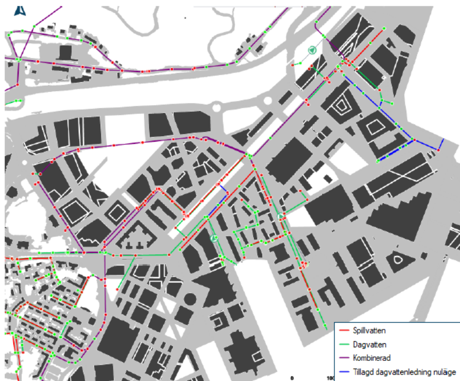
Figur 2-2 Figuren visar framtida situation från kapacitetsutredningen. Scenario 2b - framtid. Noder där trycklinje överstiger marknivå vid 30-årsregnet i rött och noder där trycknivå understiger marknivå i grönt (Kretslopp och vatten, 2020).
